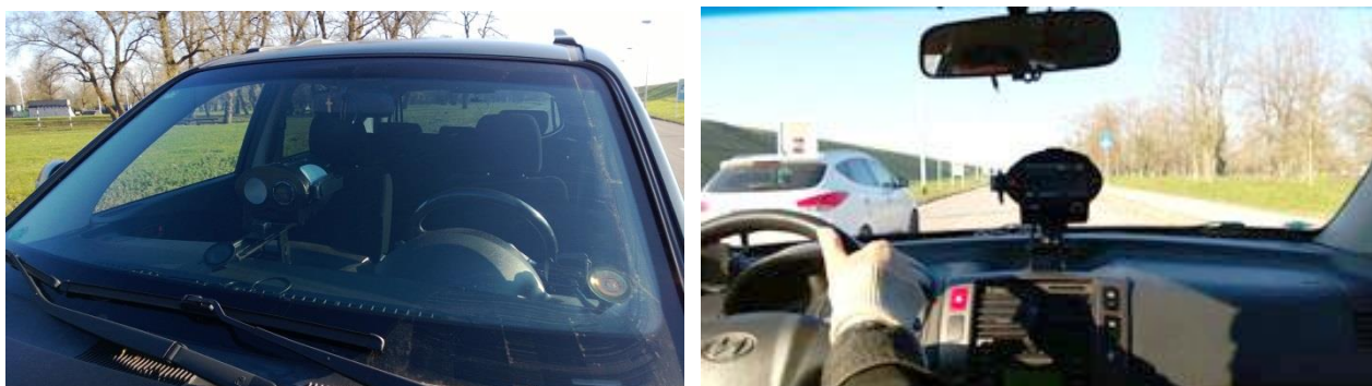
Slika 17. Prikaz postavljanja mjerila i mjerenja iz ophodnog vozila
